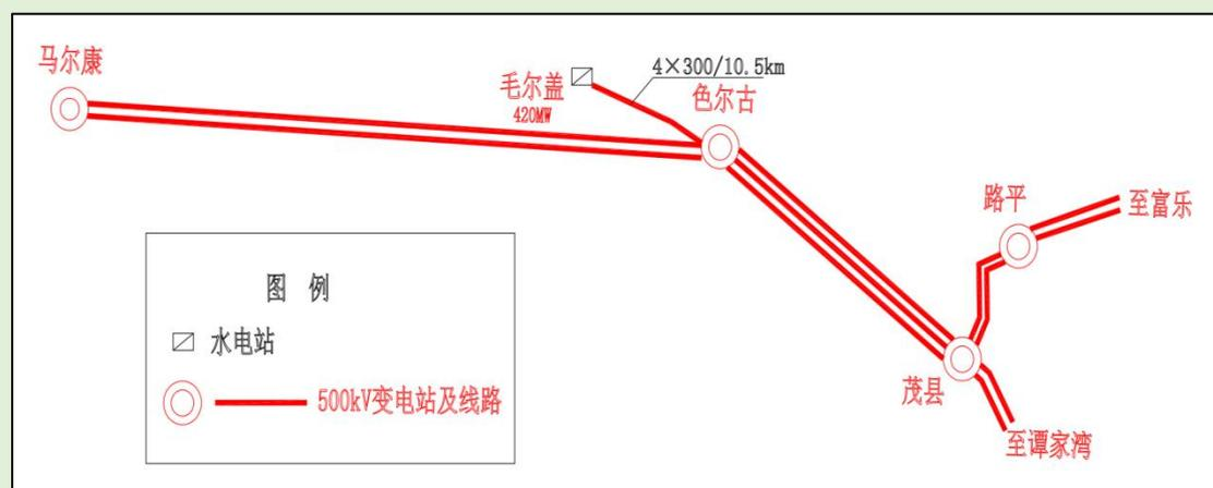
图 3-1 毛尔盖水电站接入系统方案示意图
